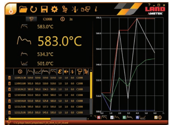
Schermata di misurazione con temperatura istantanea, una tabella che elenca le misurazioni recenti e una visualizzazione delle tendenze nelle stesse letture.
