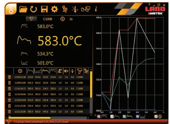
Écran de mesure avec température instantanée, affichage d'un tableau avec une liste des mesures récentes plus affichage des tendances des mêmes lectures.
