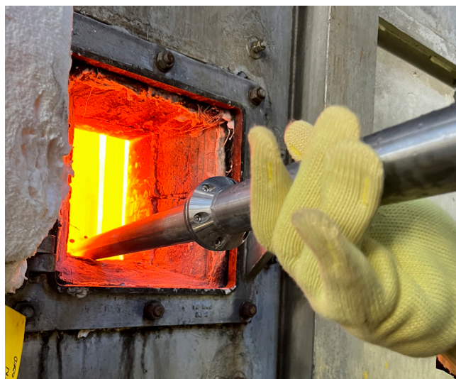
エチレン炉で使用される直線型モジュラーゴールドカップ。
