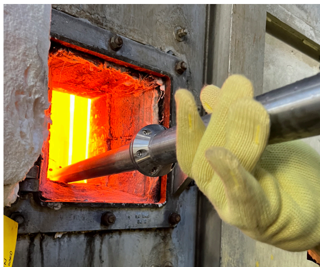
Un Gold Cup Modular recto utilizado en un horno de etileno.
