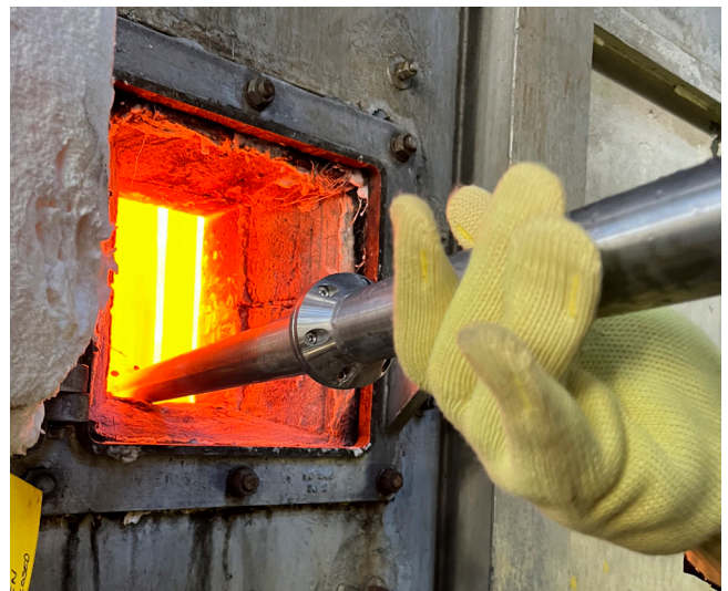
Ein gerader modularer Gold Cup, der in einem Ethylenofen verwendet wird.
