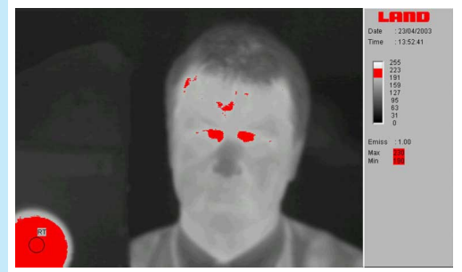
Fonction isotherme révélant les points chauds correspondant à la consigne
