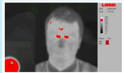
Isothermenanzeige mit Sollwertvorgabe durch Referenzstrahler
